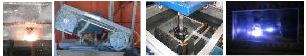
レーザー切断 機械切断(バンドソー) ウォータジェット切断 プラズマ切断
