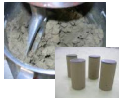
廃棄体化技術開発の例 (焼却灰のセメント固化試験)
